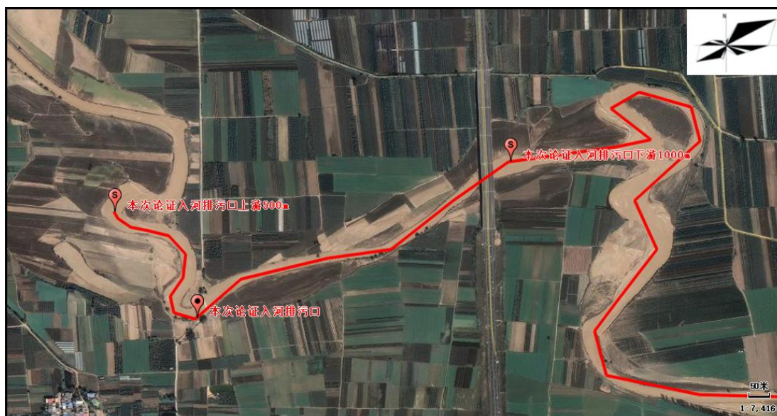
图 7-1 入河排污口上游 500m、下游 1000m 监测断面示意图
